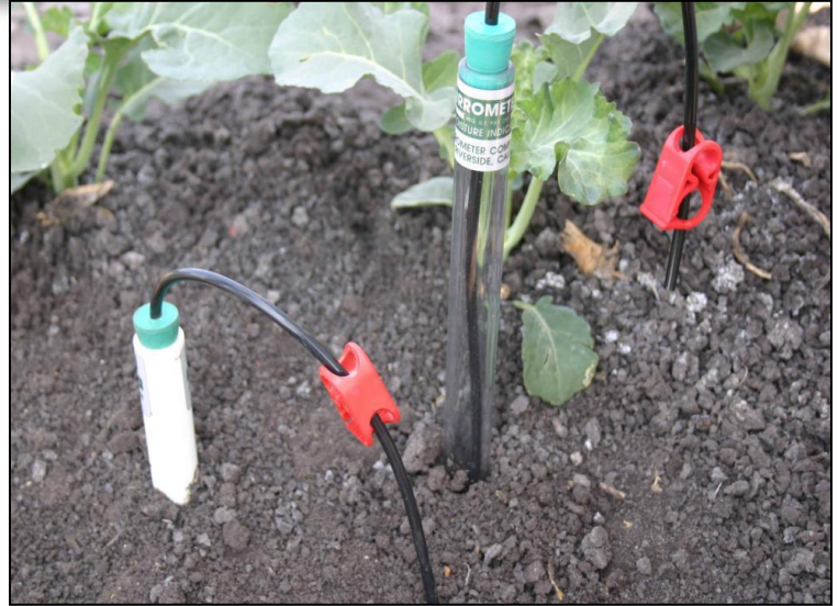
Figura 1. Los tubos de acceso o chupatubos, son un método económico y confiable de monitorear la solución del suelo, ya que no se requiere estar muestreando suelo.
